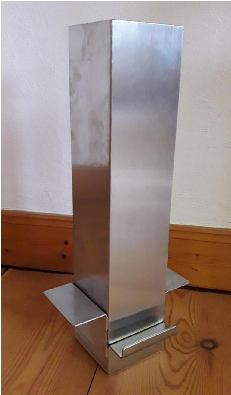
Abbildung 2: Benthos-Stechkasten, eine Sonderanfertigung für dieses Projekt mit einer Volumenentnahme von 10x10x5 cm (500 cm 3 ). Der Stechkasten wird 10 cm in den Gewässergrund hineingesteckt und mit Hilfe des seitlichen Schiebers werden die obersten 5 cm des Benthos abgetrennt und die Probe kann so entnommen werden.
